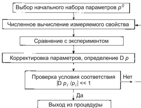
Рис. 5.11. Схема итерационного цикла подгонки параметров потенциала.
